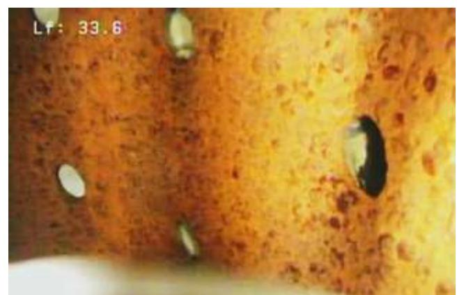
Crépines ouvertes et craie visible à travers les crépines sur F3 à 33.6m - Diagnostic IDEES EAUX le 31/01/2024
